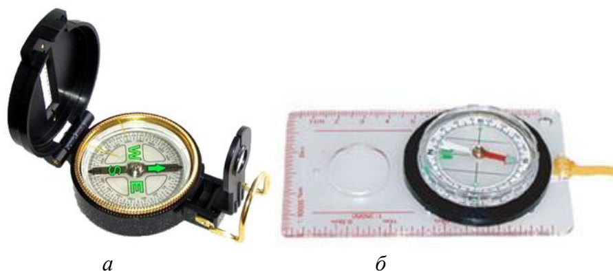
Рис.5. Типы компасов: а) нежидкостной, б) жидкостной на плато
