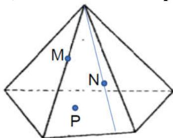
3. **Используя внутреннее проецирование** построить сечение призмы плоскостью MNP (Точки M, N, P расположены соответственно на боковой грани, на боковом ребре и на основании **так, как показано на рисунке**).
